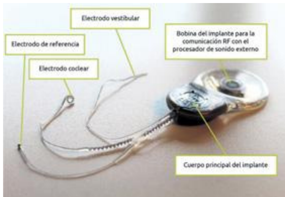
Implante diseñado por el equipo de Ingenieros del SIANI de la Universidad de Las Palmas. c7
